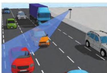
رادار دوپلری: از امواج الکترومغناطیسی نیز می‌توان برای مکان‌یابی پژواکی و تعیین تندی اجسام استفاده کرد .
